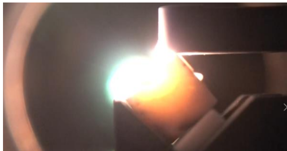
レーザー強度 2.10\text{GW}/\text{m}^2 チャンバー内雰囲気気圧 0\text{kPa}
