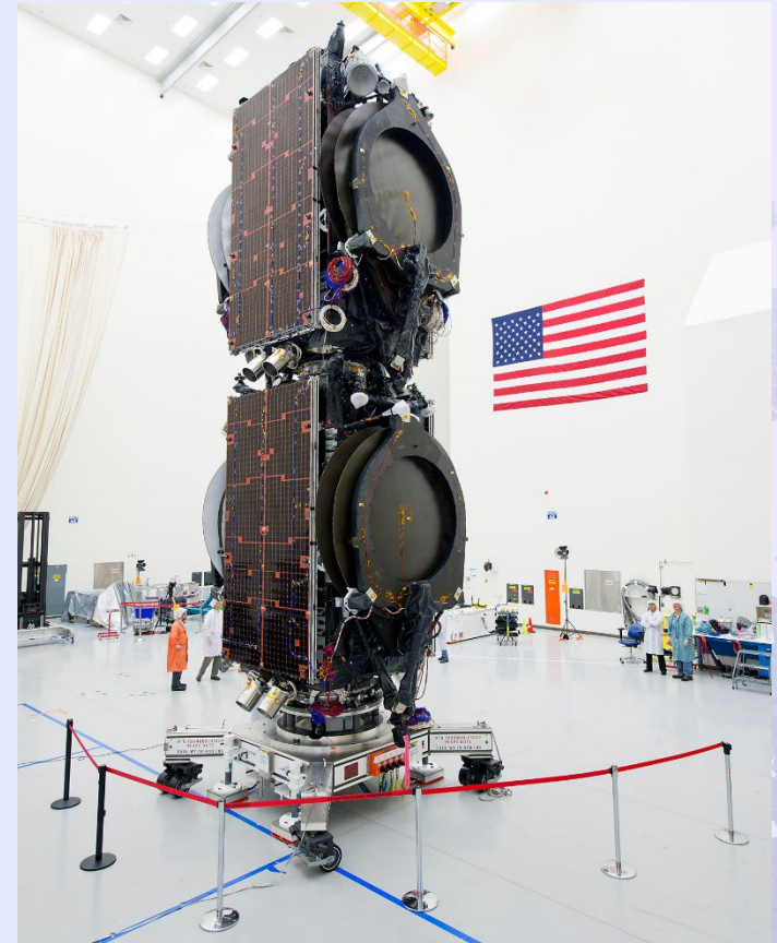
2つの全電化衛星（静止衛星）がステージに組み上げられた様子。2015年3月2日打上成功、9月10日運用開始（クレジット: Boeing）
