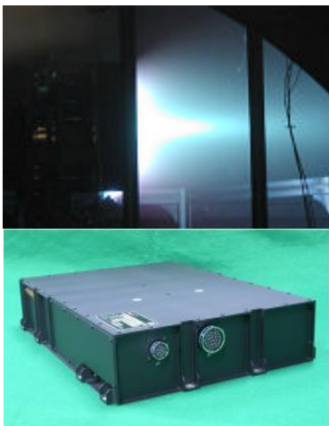
Fig. 5 200mN class hall thruster EM and PPU EM.
